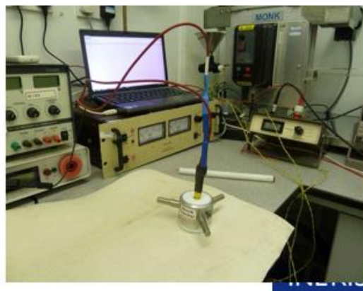
Figure 4 : Vues des montages de réalisation de la mesure de la résistance de surface et transversale de géomembranes
