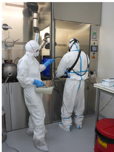
Figure 1 : (a) Mesure des concentrations en nombre de particules à proximité de l'opérateur et en fond au cours d'essais d'explosivité de NC et de NTC (Source : ISSeP) ; (b) Agglomérat de NC prélevé sur une grille MPS analysée par MET (Source : INERIS).
