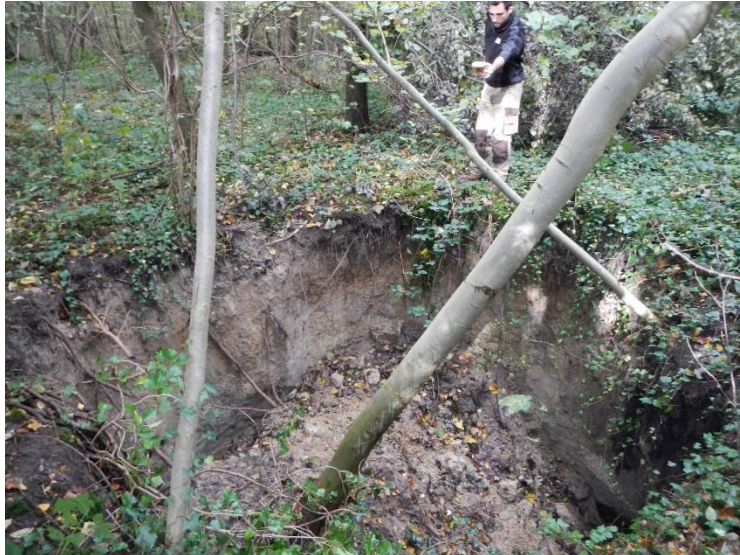
Photographie 1 : Fontis de 4 m de diamètre et 2 m de profondeur recensé dans l'enceinte du Bois de la Tussion (Seine-Saint-Denis, 93) en 2013 (Crédit INERIS)
