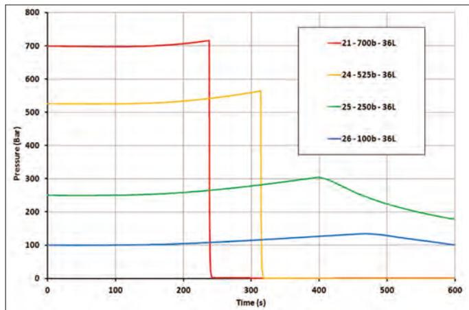
Figure 3 / Courbe d'éclatement pour un flux de 100 kW/m².
