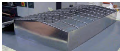
Fig1 Essai à petite échelle sur table d'explosion de l'INSA CVL réalisé en partenariat avec le CTICM : caractérisation de l'onde de surpression et de la réponse de la structure
