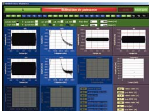
> Le programme « SABAL ». Émission d'un sweep selon la PGOS (à gauche) et l'analyse interactive des enregistrements (à droite).
