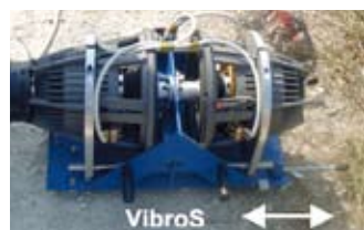
> Sources vibratoires en ondes P (VibroPA, VibroPP) et S (VibroS). Le sens de vibration est indiqué par les flèches blanches.
