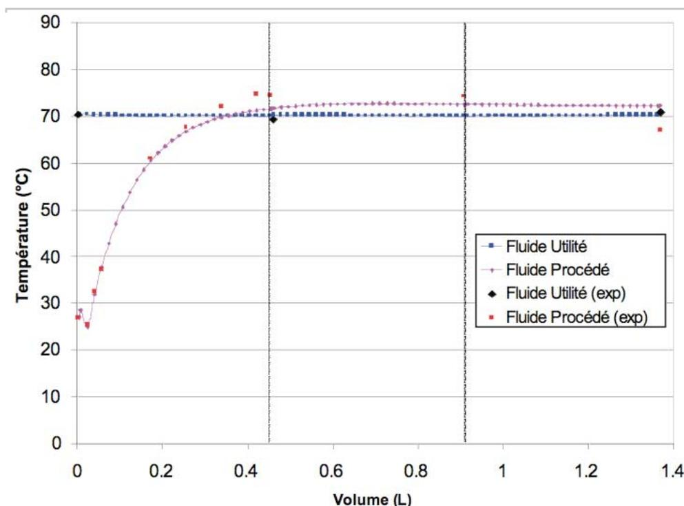
> Profils de température dans l'OPR pour la réaction d'estérification : Expérience n°1 (50 L.h<sup>-1</sup> ; 70 °C ; 0,4 %).
