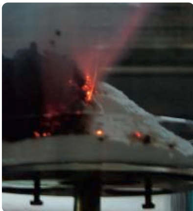
Amorçage de la combustion auto-entretenu du mélange fumigène (échantillon à 30 % de lactose, 30 % de fécula de pomme de terre et 40 % de \text{KNO}_3 ).
