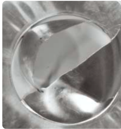
1 mm, Al 2017 après détonation (0,6 bar).
