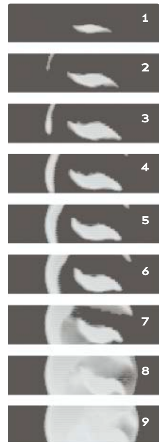
Développement d'une fissure sur une plaque (intervalle d'acquisition de 10^{-4} secondes).
