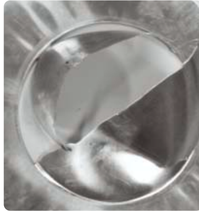
1 mm, Al 2017 après détonation (0,6 bar).
