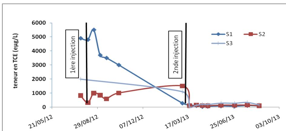
**Figure 1. Evolution des concentrations en TCE au droit des 3 ouvrages d'injections en zone source**
