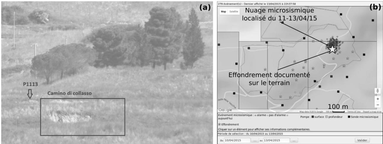
Figure 5 : (a) photo de l'effondrement d'Avril 2015 prise par l'exploitant, (b) la localisation de la crise microsismique (nuage de points noirs), position réelle de l'effondrement observé sur le terrain.
