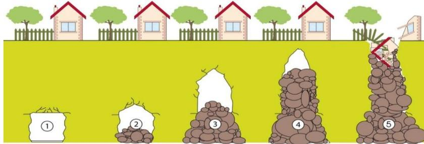
Figure 1. Mécanismes de développement de fontis au droit d'une cavité souterraine en 5 étapes. Source: Nadim et al, 2013.
