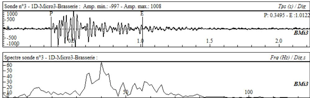
Figure 2. Signal acoustique typique lié à une chute de bloc et enveloppe spectrale du signal et niveaux de pression. Source : Données INERIS.
