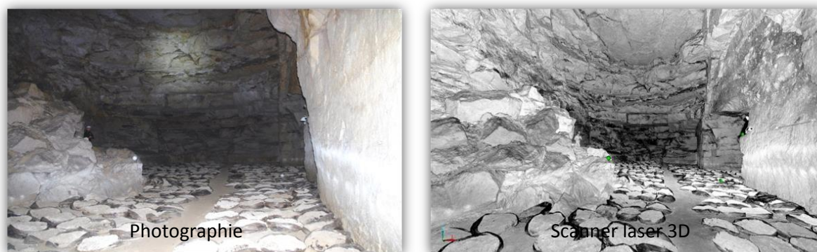
Figure 12 : Comparaison entre photographie et scan d'une carrière souterraine
