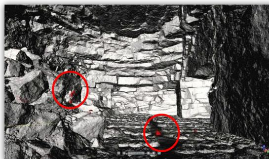
Figure 16 : Détection d'une chute de blocs
