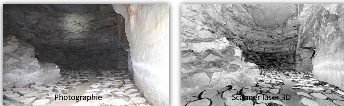
Figure 12 : Comparaison entre photographie et scan d'une carrière souterraine
