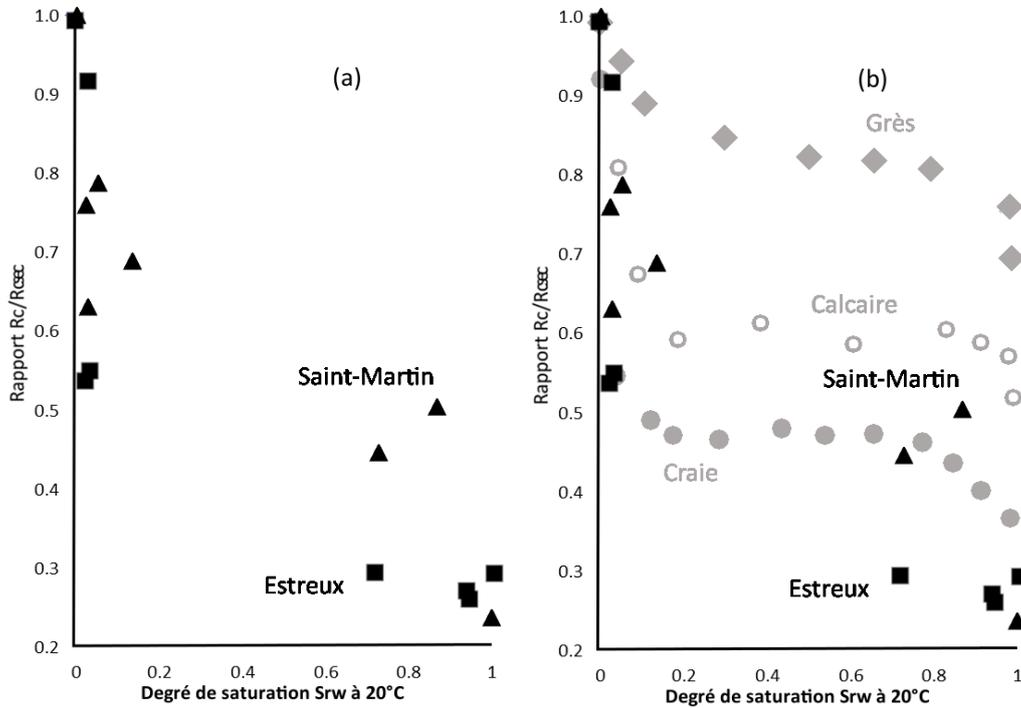
Figure 2. Ratio de résistance  $R_c(Hr)/R_c(sec)$  en fonction du degré de saturation  $S_{rw}$  à 20°C. (a) craies d'Estreux et de Saint-Martin-le-Noeud, (b) comparaison avec des données de littérature (Watelet 1996)
