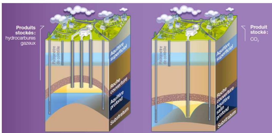
Figure 2. Schéma de stockages en aquifère profond (INERIS, 2016)
