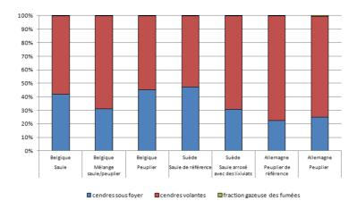
Figure 1. Répartition des émissions de Zn lors des essais de combustion.
