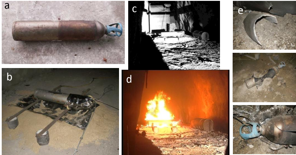
Figure 1 : (a) Bouteille en test, (b, c) dispositif avant l'essai et (d) durant l'essai, (e) fragments de la bouteille après éclatement
