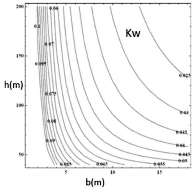
Figure 4 : Abaque permettant de trouver le module de réaction du sol  $K_w$  du modèle de Winkler en fonction de la demi-largeur de la charge  $b$  et de l'épaisseur du terrain  $h$  ( $E_t = 1 \text{ MPa}$ ,  $\nu = 0.3$ ). Pour d'autres valeurs du module de Young du terrain, il convient de multiplier les valeurs fournies par les abaques par le module de Young de terrain.
