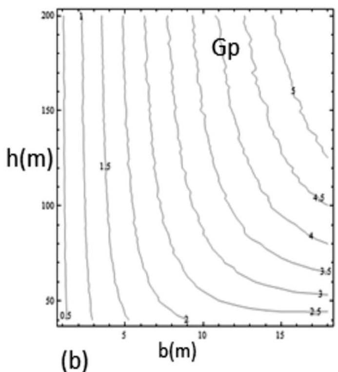
Figure 3: (a,b) Abaques permettant de trouver les modules de réaction du sol  $K_p$  (a),  $G_p$  (b) du modèle de Pasternak en fonction de la demi-largeur de la charge  $b$  et de l'épaisseur du terrain  $h$  ( $E_t = 1 \text{ MPa}$ ,  $\nu = 0.3$ ). Pour d'autres valeurs du module de Young du terrain, il convient de multiplier les valeurs fournies par les abaques par le module de Young de terrain
