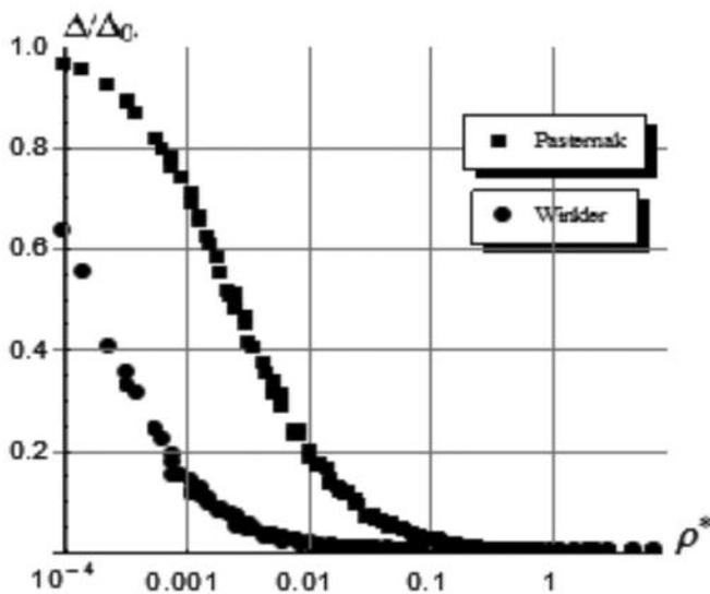
Figure 5: Taux de transmission de la déflexion (axe vertical) pour les deux modèles analytiques de Pasternak et Winkler en fonction de  $\rho^* = EI/(8.E.L^2)$ .
