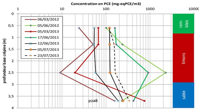
Confirmant les influences mentionnées ci-dessus, le suivi sur un quadruplet de piézais situés sous le bâtiment à 15 mètres de la source montre que des concentrations plus élevées dans les remblais et les limons (courbes vertes) pour des températures élevées ( $>25^{\circ}\text{C}$ ) et une pluviométrie faible ( $<10\text{mm}$ ) tandis que les concentrations sont plus faibles (courbes rouges) pour des températures faibles ( $<10^{\circ}\text{C}$ ) et une pluviométrie élevée ( $>25\text{mm}$ ).
