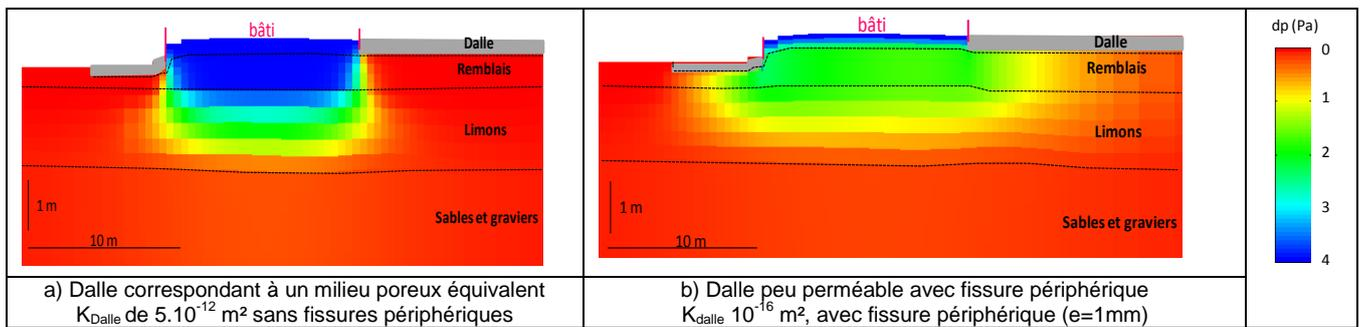
**Figure 3. Champ de dépression gaz des sols – air extérieur pour deux schématisations de la dalle**
