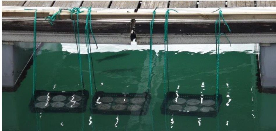
Figure 2: Exemple de positionnement d'éprouvettes dans le milieu, port de la Grande Motte, 2015
