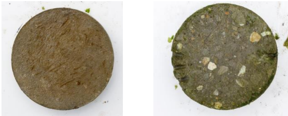
Figure 5 : 21 jours, béton B, surface coffrée (à g) colonisation par algues brunes au centre, Béton BEP surface rugueuse colonisation par algues vertes en périphérie (à d)
