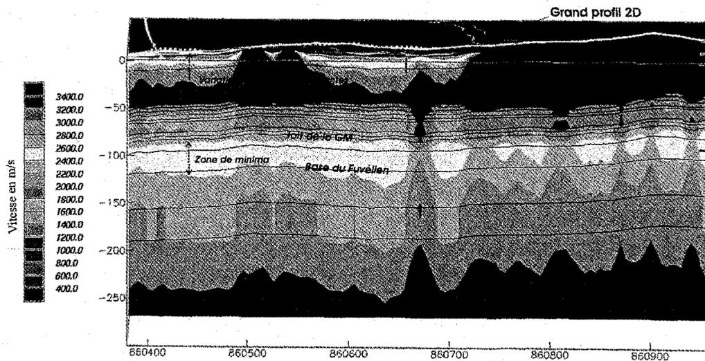
Figure 4b. Coupe du champ de vitesses moyennes déterminé à partir d'un maillage 3D. Les vitesses moyennes sont calculées verticalement entre la surface et le toit de chaque couche.
