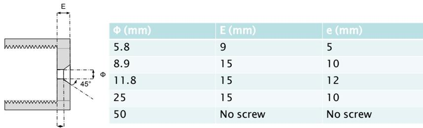
Figure 2 : Dimensions des orifices de fuite.
