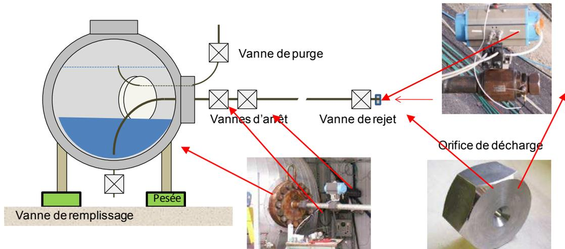
Figure 1. Installation de dépôtage. La sphère peut contenir 1tonne de CO<sub>2</sub>. La canalisation prélève le CO<sub>2</sub> en partie basse du stockage.
