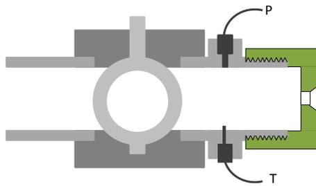
Figure 4 : Emplacement des capteurs température et pression à l'extrémité du tube
