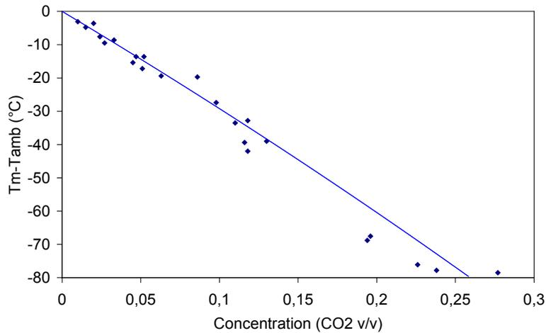
Figure 9 : Variations de température en fonction des concentrations CO<sub>2</sub> obtenues à l'aide de la mesure O<sub>2</sub>
