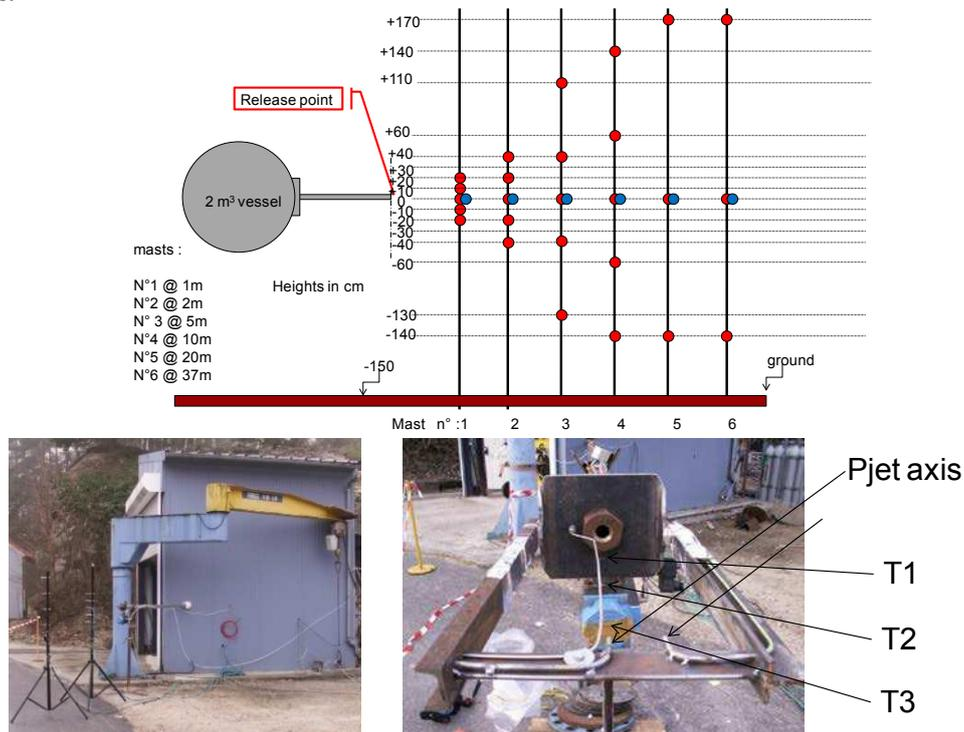
Figure 5 : schéma du dispositif de mesures dans le panache. Points rouge : mesures de température, points bleus : mesures de  $\text{CO}_2$  (et photo générale + dispositif métrologie de la zone d'expansion du jet)
