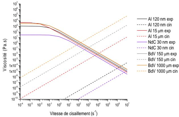
Figure 10. Evolution de la viscosité sur les trois régimes d'écoulement pour différentes poudres testées
