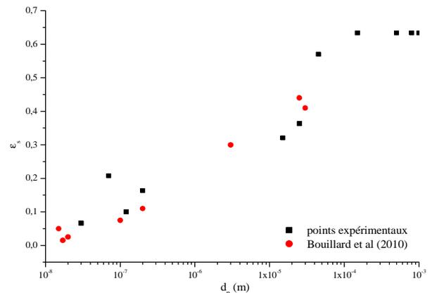
Figure 4. Evolution de la concentration en solide d'un lit de poudres en fonction du diamètre particulaire
