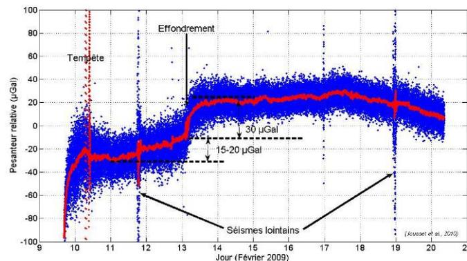
Figure 4: Variations de la pesanteur observée au moment de l'effondrement de la cavité de Cerville.
