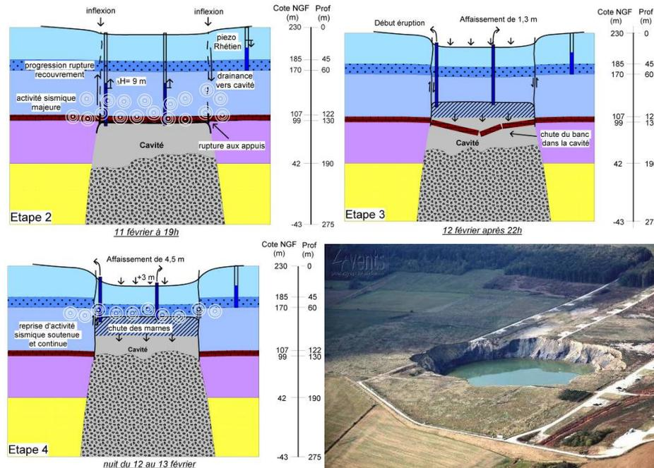
Figure 5 : Représentations schématiques de la cavité instrumentée à différentes étapes et vue aérienne de l'effondrement, été 2009 (cliché Solvay).
