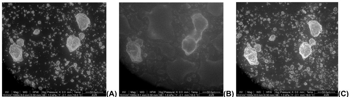
Figure 5: Evolution des agrégats d'argile verte de Romainville en fonction de l'humidité relative. Trois étapes du cycle d'humidification-séchage sont présentées : A) état initial ; B) avant la saturation totale ; C) après le séchage (Images MEBE, grandissement : 1000, échelle : 50  $\mu\text{m}$ ).
