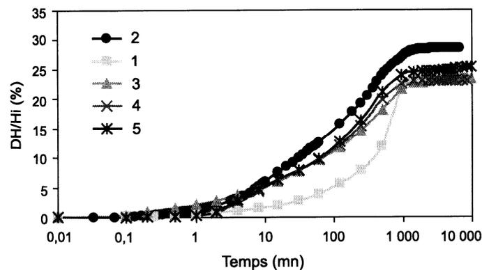
Figure 1: Essais de gonflement libre à l'oedomètre sur des échantillons remaniés d'argile verte de Romainville avec cinq cycles (Audiguier et al., 2007).
