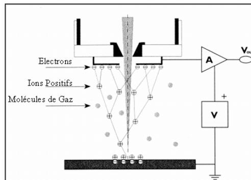
Figure 2: Représentation schématique de l'ionisation d'un gaz dans la chambre du MEBE (Montes-H., 2002)
