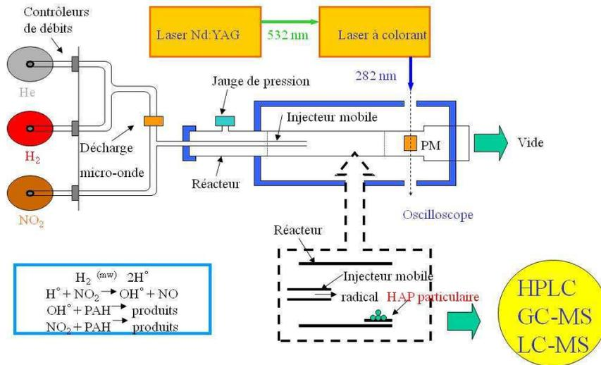
Figure 1 : Réacteur à écoulement de Bordeaux 1 (Réactions OH° et NO<sub>2</sub>)
