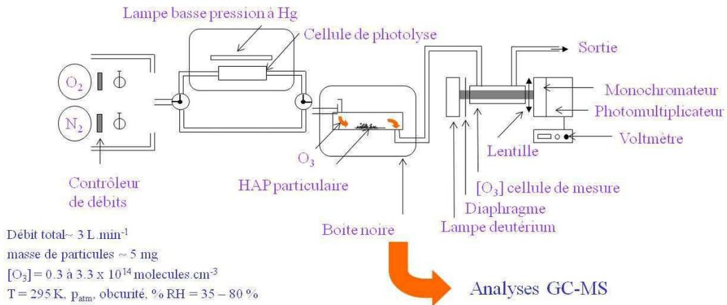
Figure 2 : Réacteur semi-statique de Bordeaux 1 (Réactions O<sub>3</sub>)
