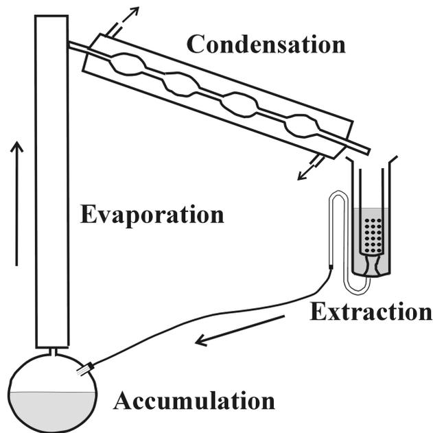
**Figure 1 – Schéma de l'extracteur de Soxhlet**
