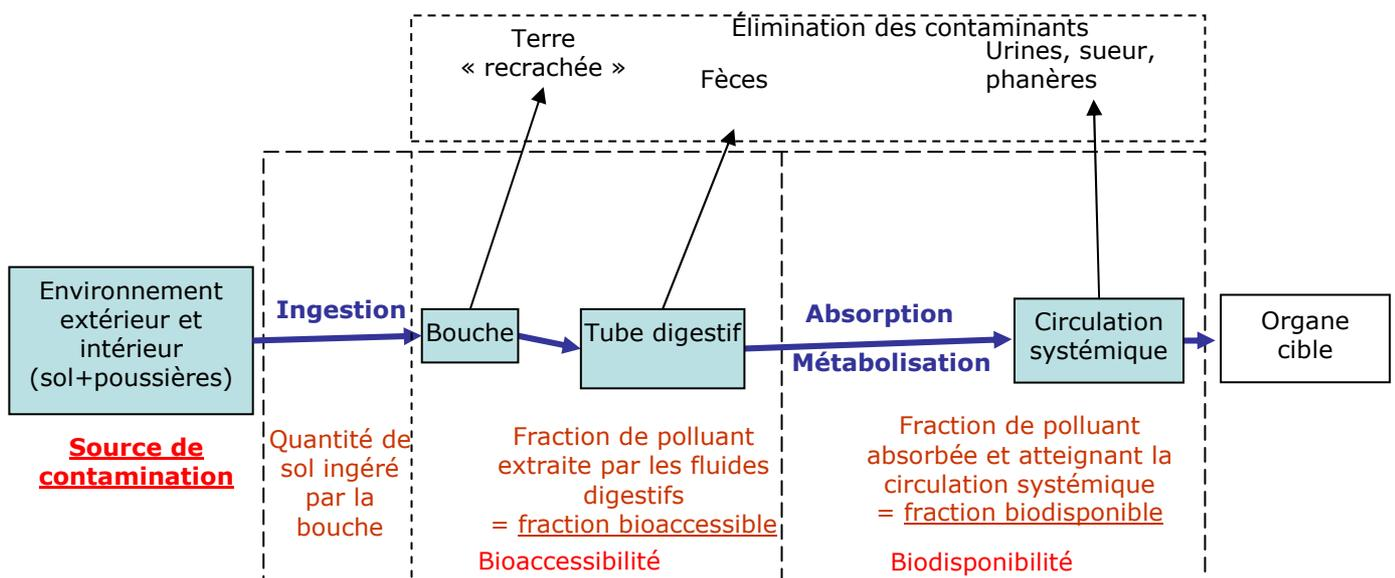
Figure 1 : Schéma conceptuel de l'exposition par ingestion de sol
