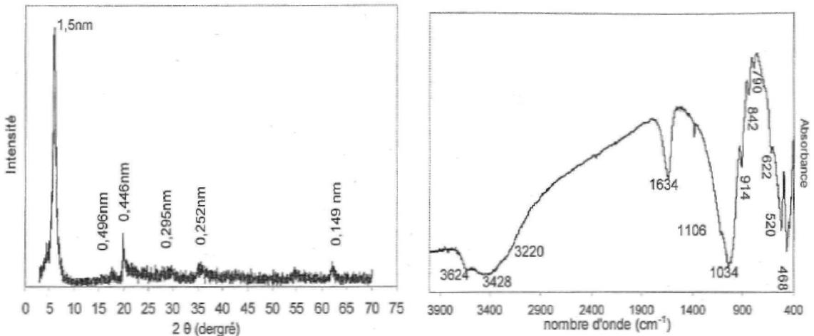
Figure 1. Diffractogramme de rayons X (à gauche) et spectre infrarouge (à droite) de l'argile grecque (Souli et al., 2004)
