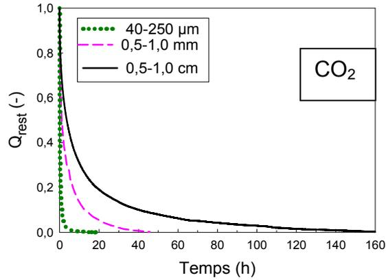
Figure 4 : Variation du  $Q_{rest}$  de CO<sub>2</sub> en fonction du temps – Effet de la granulométrie (charbon Albert séché, 298 K,  $P_{eq} = 0,1$  MPa)
