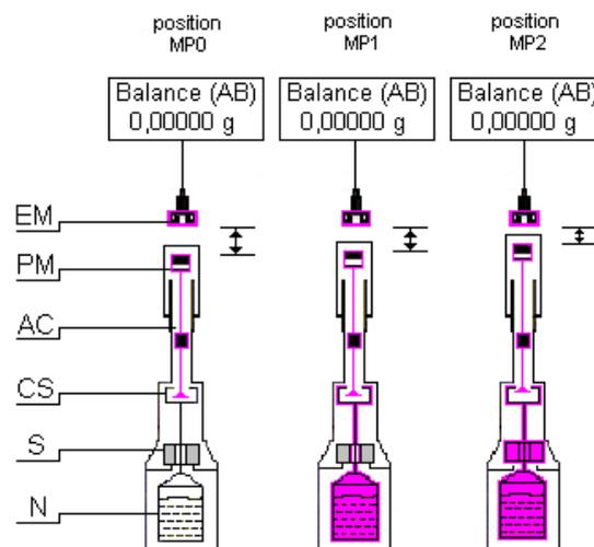
Figure 1. Balance à suspension magnétique (parties roses : parties pesées)
