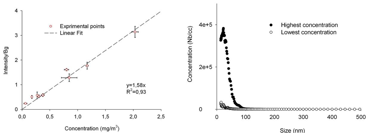
**Figure 1 : A gauche, signal spectroscopique en fonction de la concentration massique d'aérosols de cuivre dans l'air. A droite, les granulométries extrêmes de ces mêmes particules constituant l'abscisse du graphique de gauche.**
