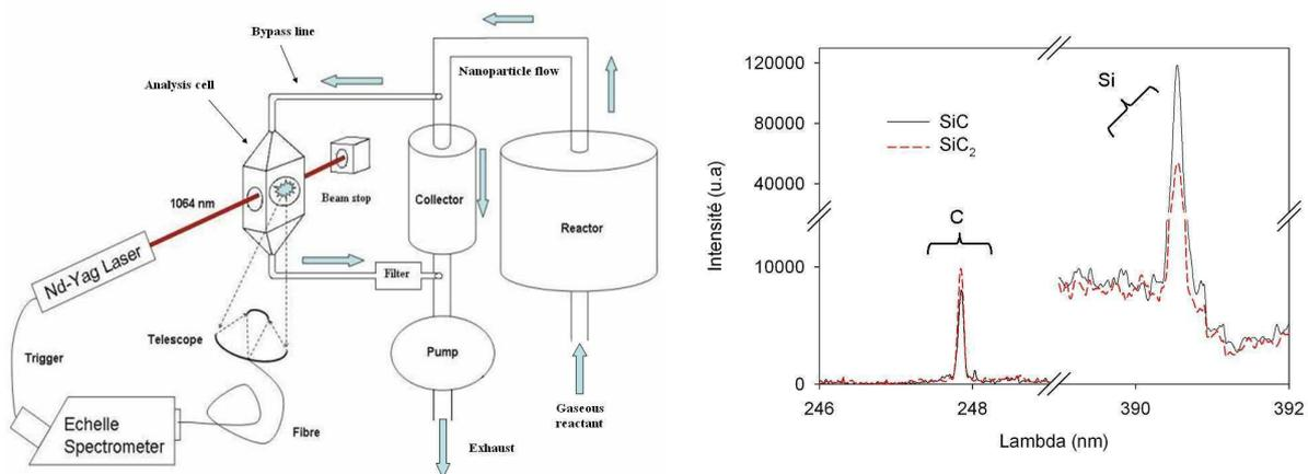
**Figure 2 : A gauche, schéma expérimental détaillant la mise en œuvre de la technique LIBS sur un réacteur de production de nano poudres. A droite, spectres bruts obtenus à partir d'une production de carbure de silice, visualisation des raies de carbone et de Silicium.**
