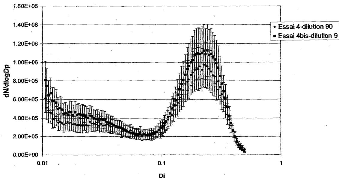
Les granulométries obtenues par le SMPS au cours de la campagne sont très comparables, puisque le mode (Dp pour lequel dN/dlogDp est maximal) pour les quatre essais est situé vers 200 nm, et que
