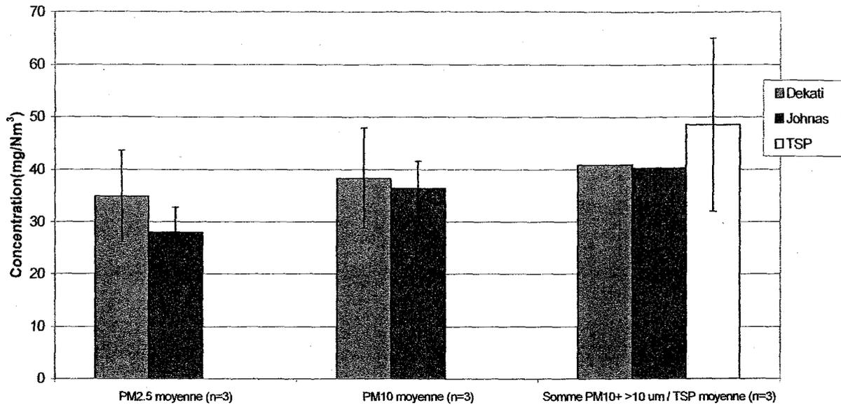
Pour les mesures PM<sub>10</sub> et PM<sub>2,5</sub>, sur la base des intervalles de confiance de répétabilité définis dans le projet de norme ISO, les résultats obtenus par les deux impacteurs peuvent être considérés comme comparables (Figure 1).
