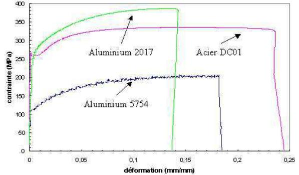
FIG. 3 – Comparatif des courbes des essais de traction effectués sur trois matériaux.
