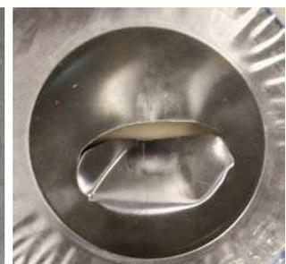
FIG. 11 – plaque de 0.5 mm en alu 5754, détonation à 0.6 bar
