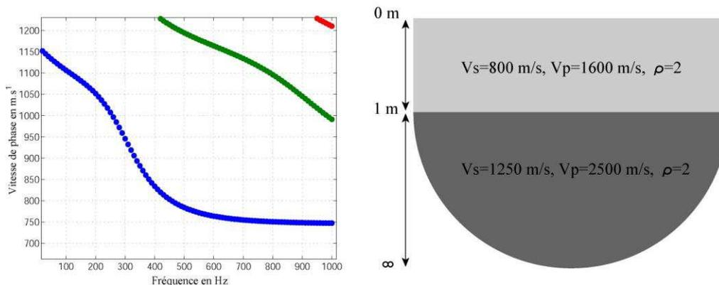
**Figure 1:** Représentation de la dispersion associée à un modèle plan
