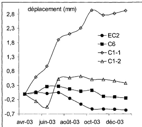
Figure 5. Convergence horizontale de galeries (nouvelles mesures)
