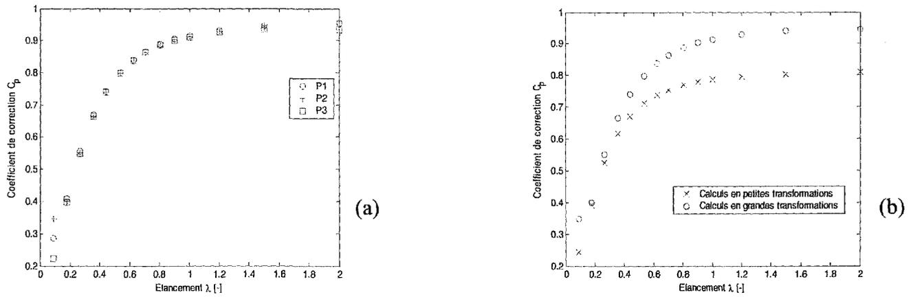
Figure 6. Coefficient de correction  $C_p$  fonction de  $\lambda$  en petites déformations pour trois jeux de paramètres  $(K, \alpha, \beta)$  (a),  $C_p$  fonction de  $\lambda$  en grandes déformations (b).
