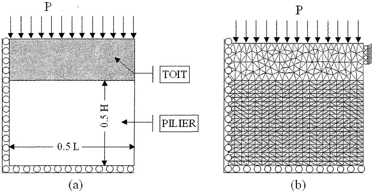
Figure 1. Modèle géométrique de base et maillage.
