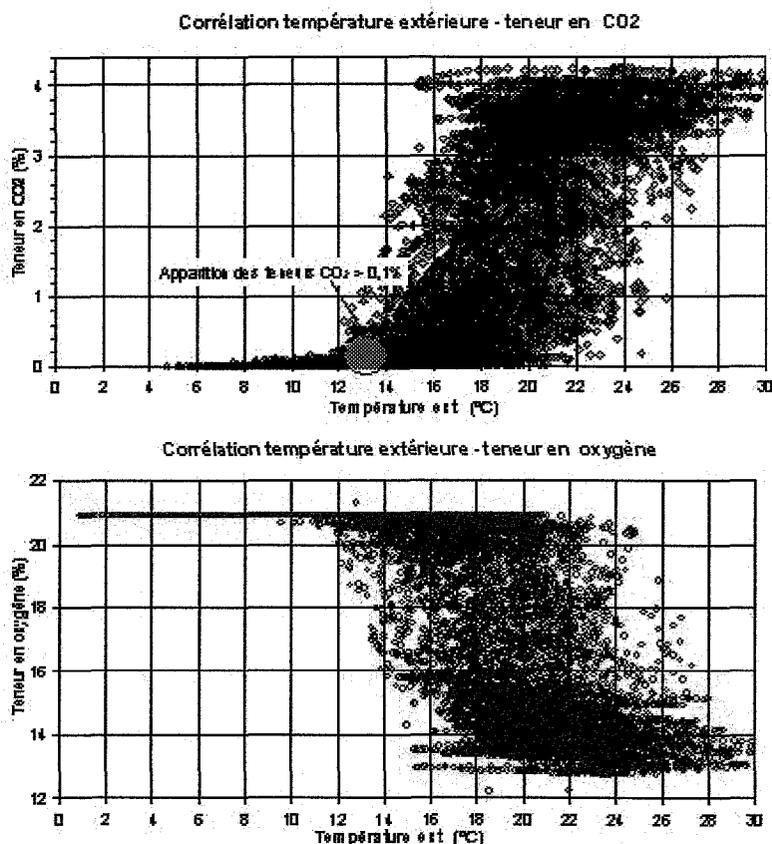
Figure 5. Corrélation entre la température extérieure et les teneurs en O<sub>2</sub> et CO<sub>2</sub> observées dans un orifice du réservoir de Moyeuve-Grande
