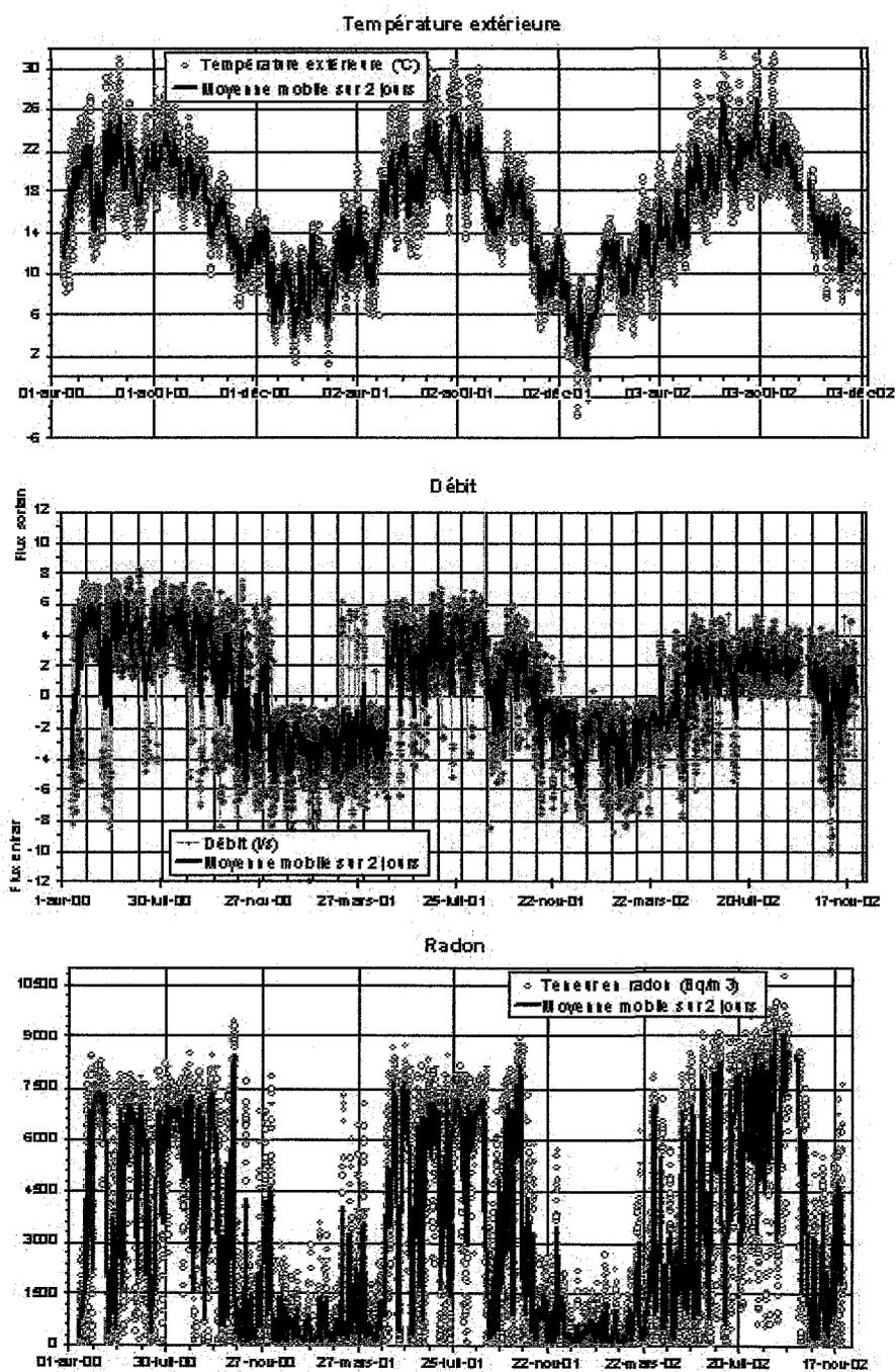
Figure 2. Evolution de la température extérieure, du débit d'air et de la teneur en radon observés dans une galerie débouchant du réservoir de Moyeuve-Grande
