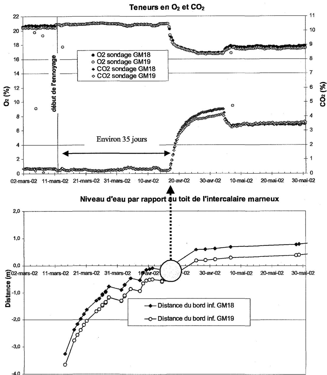
Figure 7. Evolution de la composition gazeuse dans le massif, au cours de l'ennoyage du site pilote de Tressange
