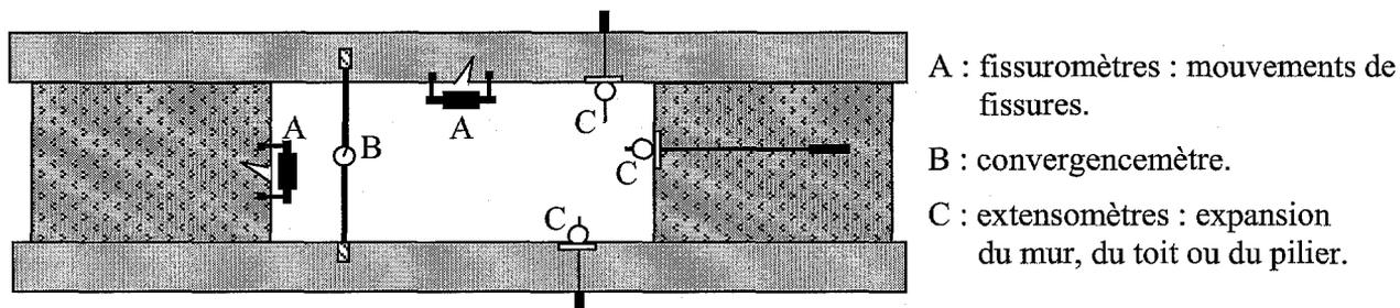
Figure 1 : Instrumentation de surveillance (*d'après Tritsch, 1995*).
