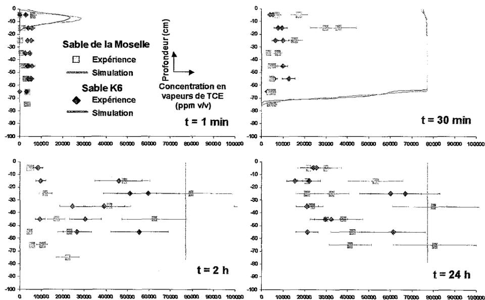
**Figure 2 – Évolution des concentrations calculées et expérimentales en vapeurs de TCE**
