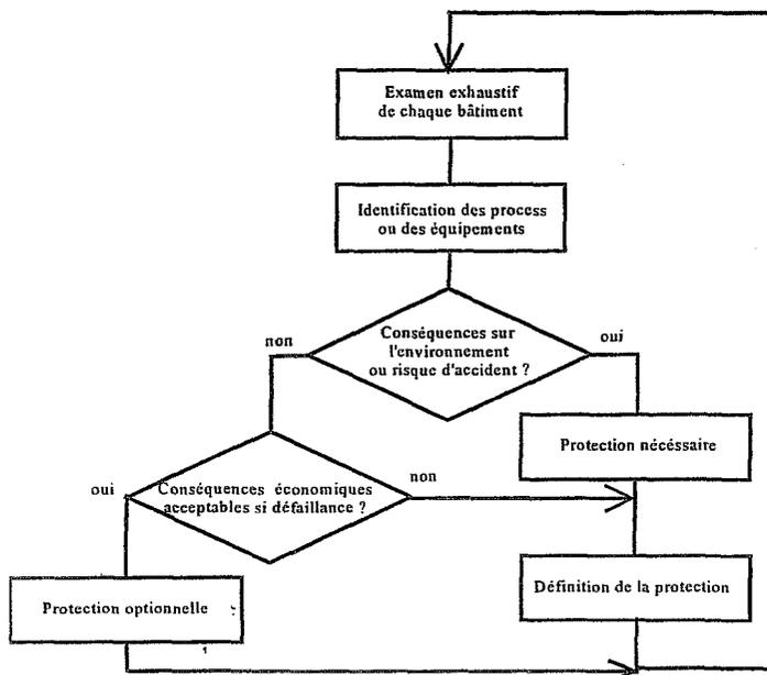
Pour appliquer efficacement cette méthode, il est souhaitable que les équipements dont la défaillance peut avoir une conséquence sur l'environnement ou être à l'origine d'un accident possèdent une fiche de vie sur laquelle sont indiquées les fonctions à vérifier. Ce suivi rigoureux permet d'attester du bon fonctionnement de l'élément à la date de vérification et le cas échéant, de déclencher une réparation ou une maintenance préventive.
