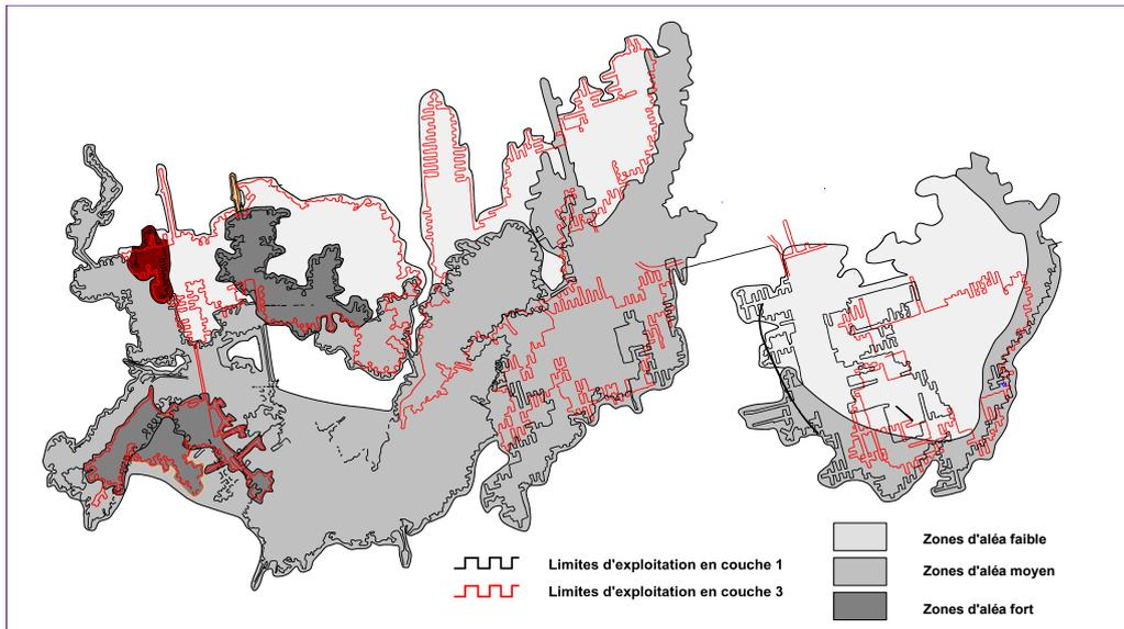
Figure 4 : Cartographie de l'aléa mouvement de terrain aux droit des anciennes cavités souterraines.
