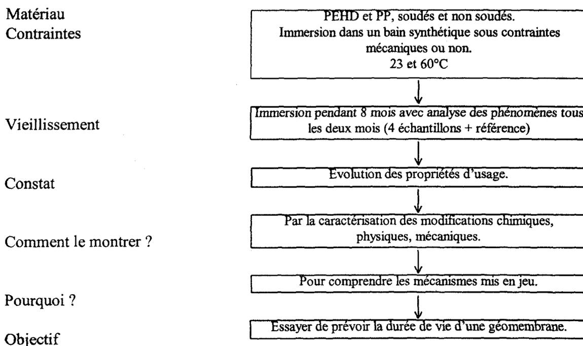
Le choix des matériaux s'est porté sur le polyéthylène haute densité (PEHD) car il est le plus couramment utilisé et sur un matériau nouveau, le polypropylène flexible (FPP).
