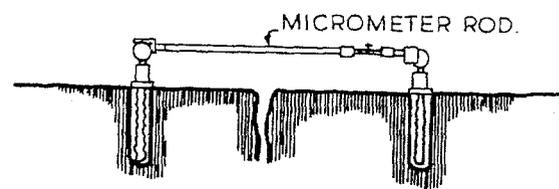
Figure 4 : Micromètre portatif
