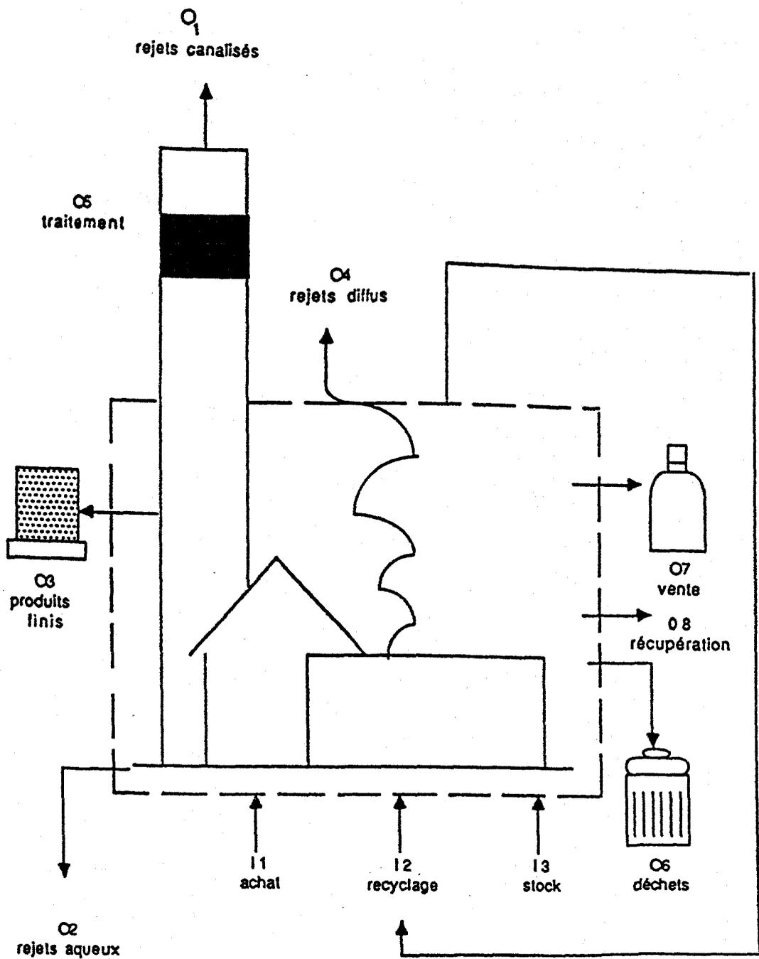
Bilan des entrées / sorties de solvants sur l'installation
