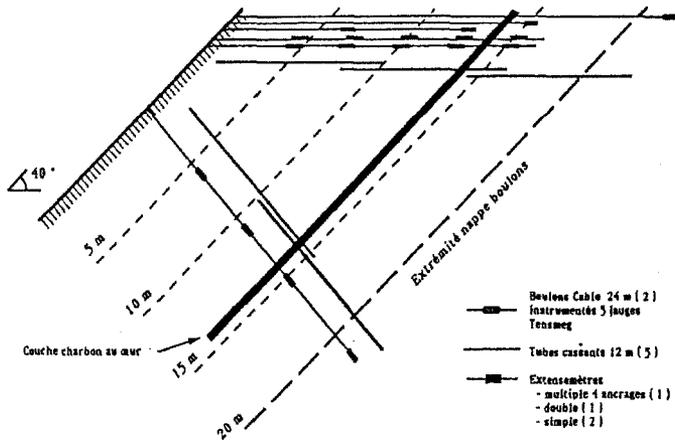
Fig. 8 : Station d'instrumentation
