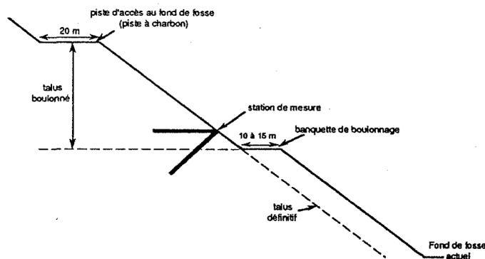
Fig. 7 : Coupe schématique du talus ouest.
