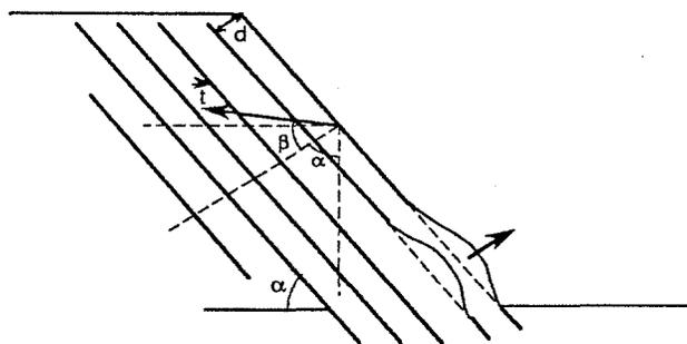
Fig. 5 : Position des boulons dans le talus
