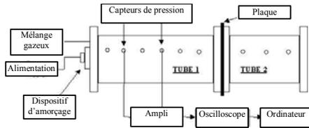
**Figure 1.** Dispositif expérimental
