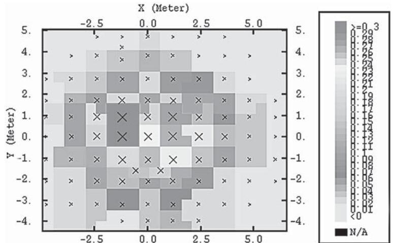
Figure 3 - Cartographie du flux total de TCE et PCE sur le site expérimental de l'Ifare (mars 2002) obtenue par krigeage ordinaire. Valeurs de flux ( $\text{cm}^3/\text{min.m}^2$ )
