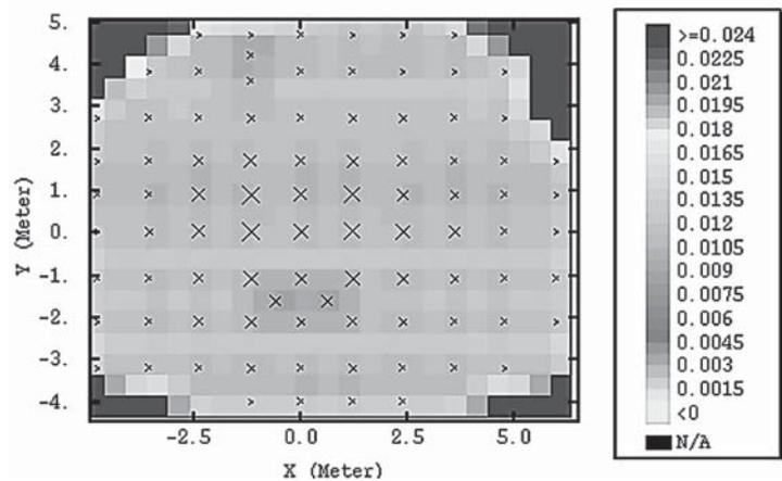
Figure 4 - Carte de l'écart-type de krigeage ( $\text{cm}^3/\text{min.m}^2$ )
