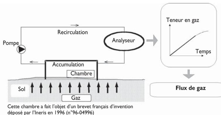
Figure 2 - Dispositif de mesure des flux
