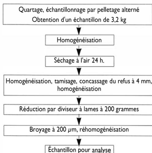
Figure 2 : Préparation de l'échantillon pour laboratoire
